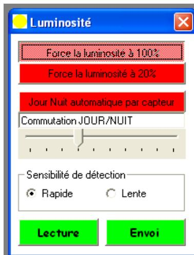
Ce module permet inhiber totalement la cellule de détection jour/nuit ou de modifier son réglage pour l'adapté au mieux à l'environnement dans lequel est installé votre afficheur.
