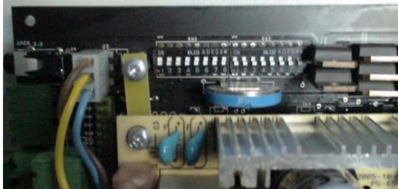
Photo d'un exemple d'emplacement de microswitches sur la carte électronique d'un afficheur
