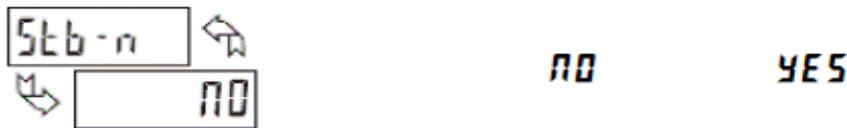
Si **YES** est sélectionné, la sortie est désactivée (après une mise sous tension) jusqu'à ce que le seuil de consigne soit franchi. Dès que la sortie est ON, cette dernière opère normalement en fonction de l'action sur seuil et du mode de reset.
