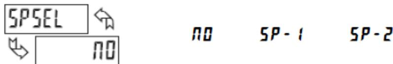
Sélectionner la sortie qui doit être configurée. Le **n** dans les paramètres qui suivent indique le N° de la sortie choisie. Après que la sortie sur seuil ait été totalement configurée, l'affichage reviendra à **SPSEL**. Répéter les mêmes étapes pour chacune des sorties à configurer. Sélectionner **n0** pour sortir du module. Le nombre de seuils disponibles est fonction de la carte à seuil installée dans l'appareil.
