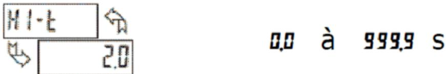
Lorsque le signal d'entrée dépasse la valeur max mémorisée, pendant un délai préalablement déterminé, l'appareil procède à la capture de cette valeur d'entrée plus élevée. Cette valeur devient alors la nouvelle valeur du max. Ce temps de vérification du maintien du signal, permet d'éviter les captures de dépassements intempestifs sur des pics de variation à durées courtes.
