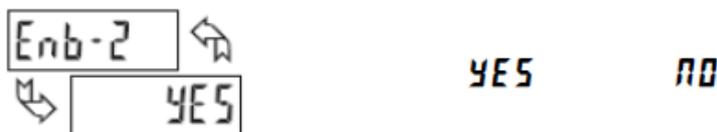
Sélectionner **YES** pour activer la sortie 2 et accéder à ses paramètres. Si **n0** est choisi, l'appareil revient à **SPSEL** et le seuil 2 est désactivé.
