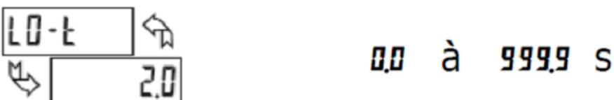
Lorsque le signal d'entrée est inférieur à la valeur mini mémorisée, pendant un délai préalablement déterminé, l'appareil procède à la capture de cette valeur d'entrée plus basse. Cette valeur devient alors la nouvelle valeur du mini. Ce temps de vérification du maintien du signal, permet d'éviter les captures de dépassements intempestifs sur des pics de variation à durées courtes.
